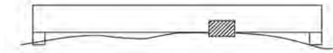
CASO 02 IL REGOLO NON TOCCA IL PAVIMENTO E IL TASSELLO NON PASSA SOTTO IL REGOLO: PLANARITÀ ENTRO TOLLERANZA
