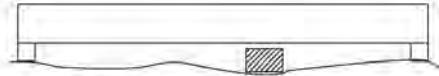
CASO 03 IL REGOLO NON TOCCA IL PAVIMENTO E IL TASSELLO PASSA SOTTO IL REGOLO: CAPOVOLGERE IL REGOLO
