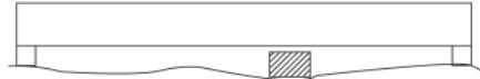
CASO 03 IL REGOLO NON TOCCA IL PAVIMENTO E IL TASSELLO PASSA SOTTO IL REGOLO: CAPOVOLGERE IL REGOLO
