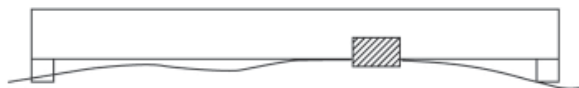
CASO 02 IL REGOLO NON TOCCA IL PAVIMENTO E IL TASSELLO NON PASSA SOTTO IL REGOLO: PLANARITÀ ENTRO TOLLERANZA
