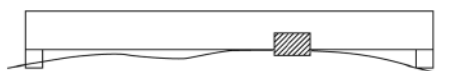
CASO 02 IL REGOLO NON TOCCA IL PAVIMENTO E IL TASSELLO NON PASSA SOTTO IL REGOLO: PLANARITÀ ENTRO TOLLERANZA
